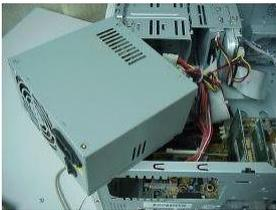
**La Fuente de Alimentación**, es un montaje eléctrico/electrónico capaz de transformar la corriente de la red eléctrica en una corriente que el ordenador pueda soportar. Tensión de entrada 220V-Tensiones de salida de +-5 y +-12 voltios.
