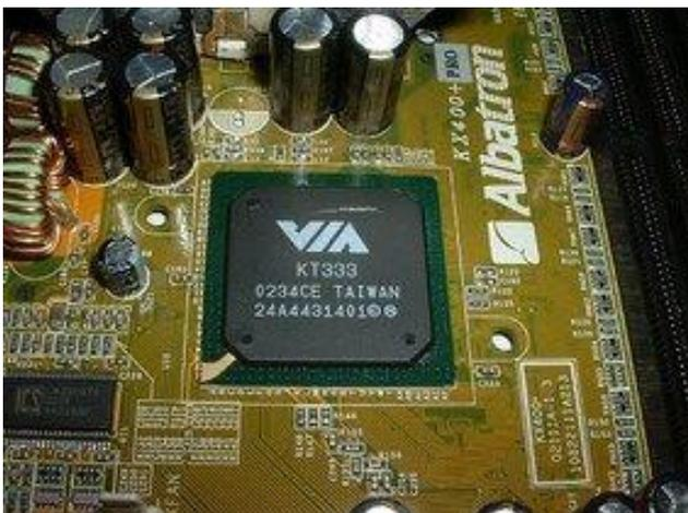
**Ojo no confundir con el micro. El micro no se ve porque lleva encima el ventilador.**
